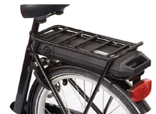
Si vous voulez retirer la batterie, déverrouillez au préalable le support de batterie en tournant la clé de batterie vers la droite. Retirez ensuite la batterie de la boîte de contrôle en tirant la poignée sur le bas de la batterie.
