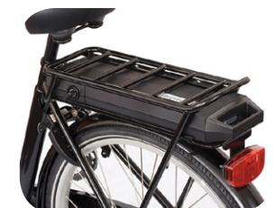
Zum abkoppeln des Akkus schließen Sie das Akkuschloss auf indem Sie den Schlüssel rechtsum drehen. Anschließend ziehen Sie den Akkus mit Hilfe des Handgriffes aus der Controllerbox.
