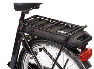
Wanneer u de accu wilt loskoppelen, ontgrendelt u eerst het accuslot door de accusleutel rechtsom te draaien. Vervolgens haalt u de accu uit de controllerbox door deze via het handvat aan de onderkant van de accu eruit te trekken.
